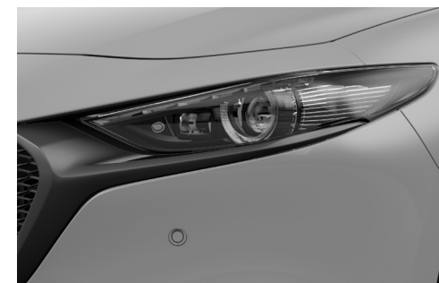
Adaptives Matrix-LED-Lichtsystem (Evolution ALH)
