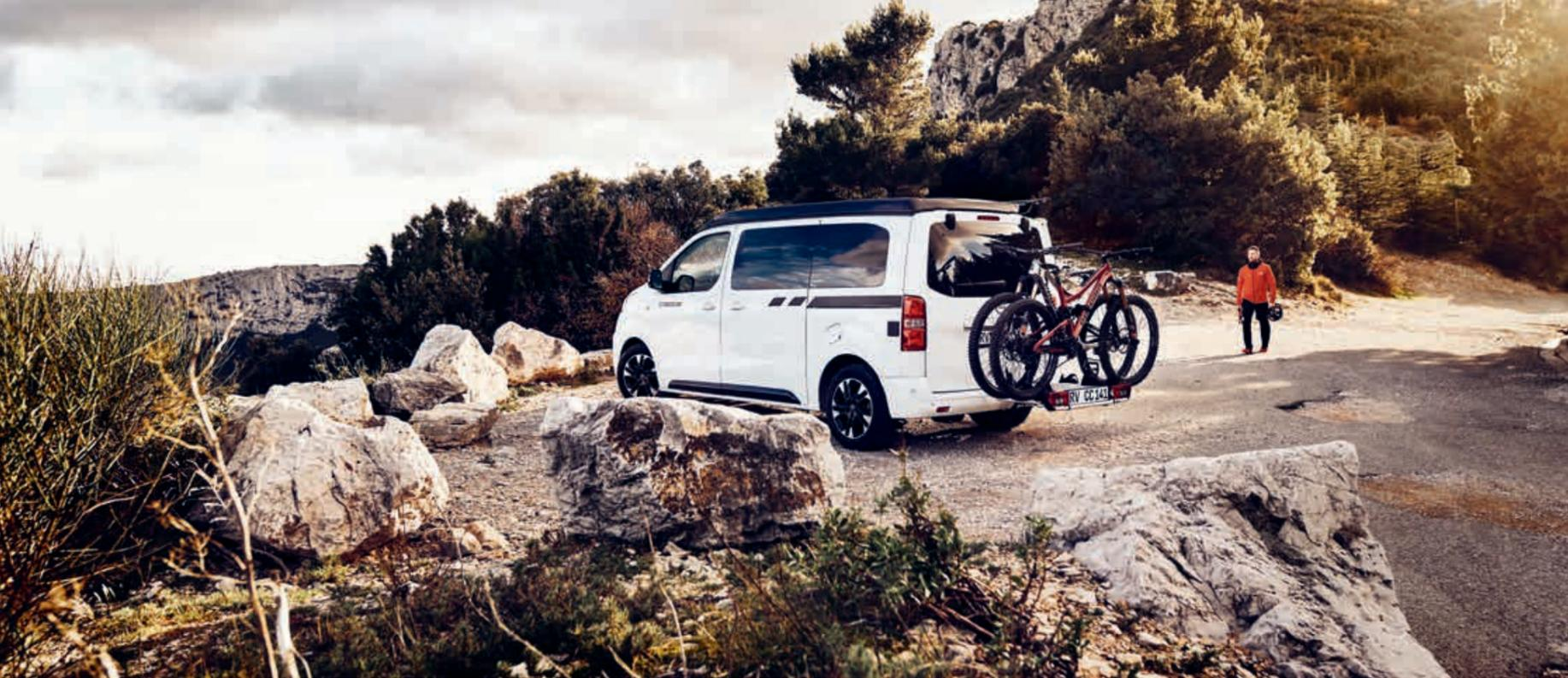
▲ Der abnehmbare Fahrradträger für die Anhängerkupplung kann bis zu drei Bikes aufnehmen und lässt sich für einen einfachen Zugang zur Heckklappe kippen.
